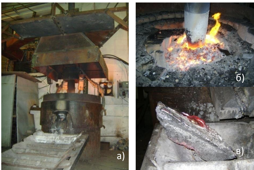
Рисунок 1 – Общий вид однофазной руднотермической печи (а), состояния колошника (б) и слитков сплава полученной, бесшлаковым способом (в)
