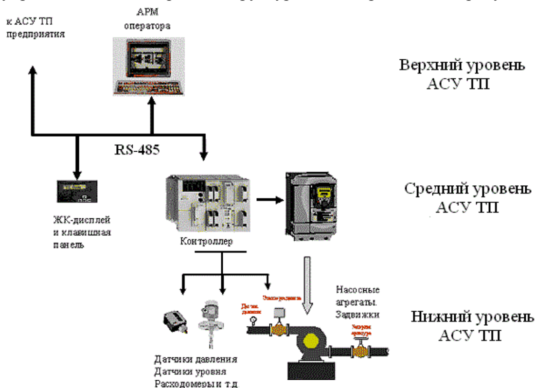
Рисунок 1 Структурная схема управления АСУ ТП
